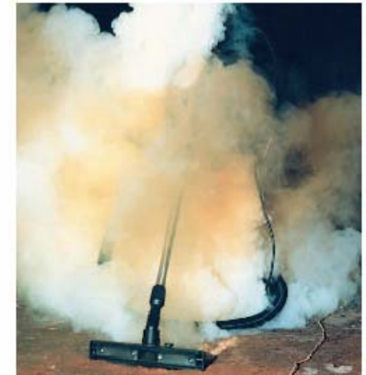
Bild 2: Abbrand von 100 g Treibladungspulverresten bei laufendem Motor
